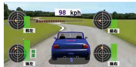
可視化された「タイヤ力」のイメージシミュレーションによるCG再現
